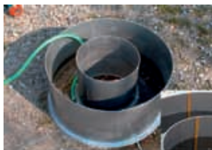
Abb 7: Messung der Wasserdurchlässigkeit mittels stationärem Doppelringinfiltrometer
